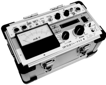
外形寸法・重量 : 280(W) × 206(D) × 174(H)mm ・ 約5kg
