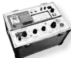
DI-11N と IP-701G と組合せて「高圧ケーブルの絶縁劣化診断」に最適
