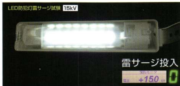
15kVの電圧をかけても変化なし
