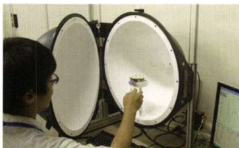
試験機から取り出した発光部を光束測定器で測定。
