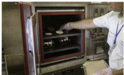
発光部を試験機に入れ、腐食性ガスで満たす。
