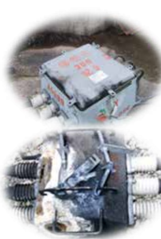
構内電柱上に設置した高圧交流 負荷開閉器への落雷
